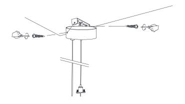
08 CONNECT 24 VOLT POWER FROM THE DRIVER TO THE 24 VOLT ON THE TRACK' RED WIRE TO POSITIVE AND BLACK WIRE TO NEGATIVE ATTACH THE WIRE RESTRAINT TO THE POWER CORD.
