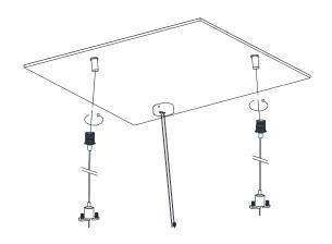
09 ADJUST SUSPENSION CABLE TO DESIRED HEIGHT BY PUSHING DOWN ON CABLE GRIPPER AND PULLING THE EXCESS CABLE. ONCE HEIGHT IS FINAL, CUT OFF EXCESS CABLE.
